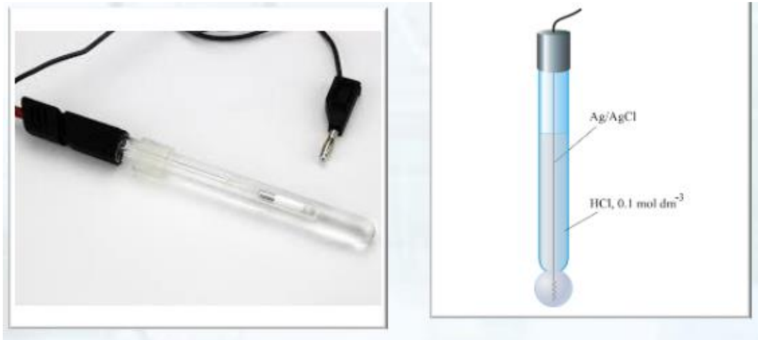
الشكل (37) مسرى الفضة. - كلوريد الفضة المقارن
